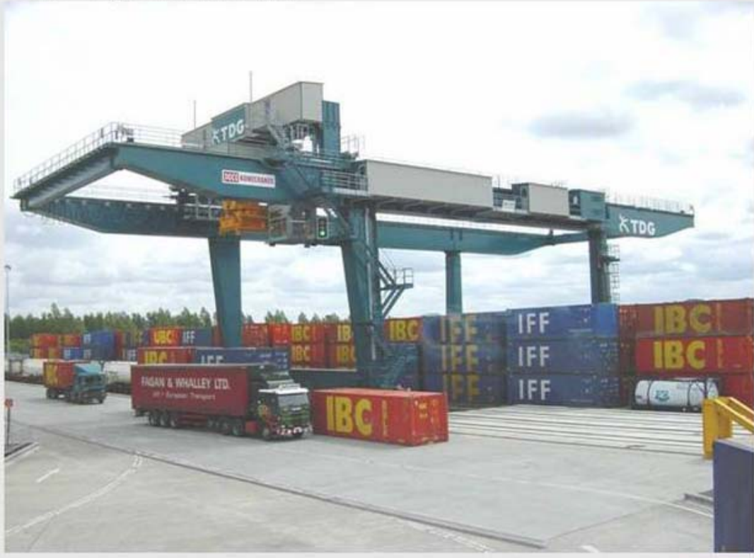
شکل ۱- جرثقیل های دروازه ای دارای دو دستک در طرفین
